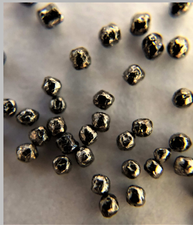
Una muestra de granalla CW acondicionada, podría incluir algunas particular cilíndricas insuficientemente acondicionadas
